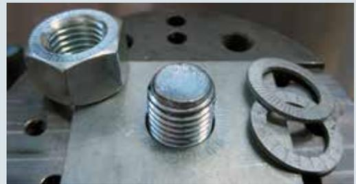
松开后，螺栓头上和母材的接触面上都必须有印迹。
